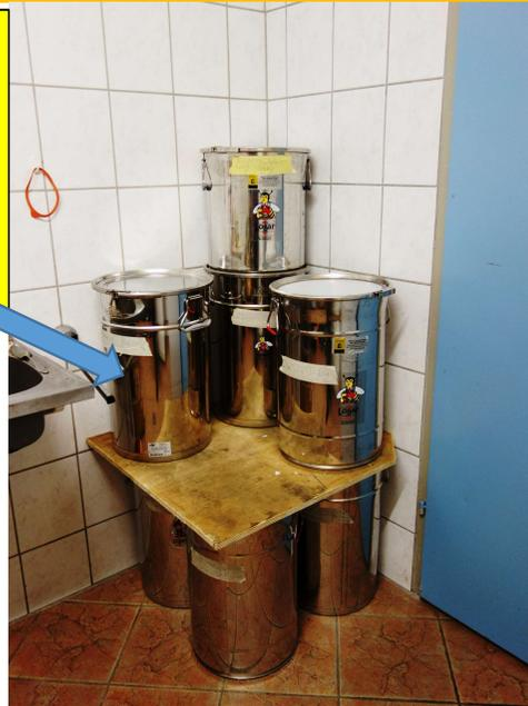
Damit man den Honig in Gläser abfüllen kann muss dieser erst verflüssigt werden in einem Wärme Schrank. Dazu habe ich eine alte ausgediente Gefriertruhe zweckentfremdet. Sie liegt auf der Seite und ist ca. 30cm aufgebockt. Als Wärmequelle nütze ich einen alten Haar Föhn, der mit einem elektronischen Thermostat (Kostenpunkt €35) gesteuert wird Die Erwärmung des Honigs dauert bei einer Temperatur von 40°C- 45°C etwa 24 Stunden.
