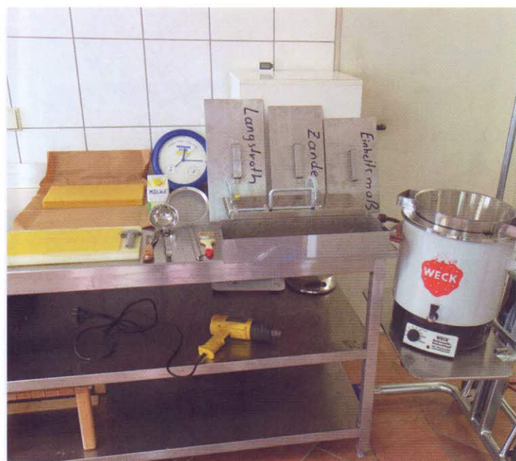
Bild 19: Aufstellung der Mittelwandgießanlage.
